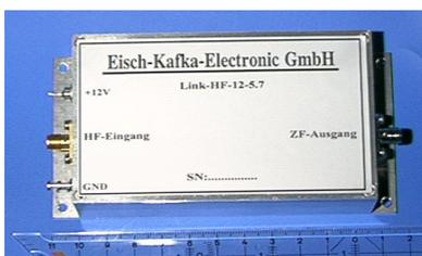
Eingangsteil für den Bereich 5,7GHz. Das HF-Teil ist über das gesamte 6cm-Band abgleichbar. Es enthält keinen Oszillator und ist für eine ZF von 110,592MHz ausgelegt. Es ist durch den Einsatz eines Schottky-Mixers von 10dBm sehr grossignalfest. Die Eingangsstufe hat eine Eingangsanpassung von >7dB wodurch ein problemloser Anschluss an Filter und Weichen möglich ist.
